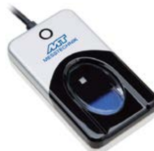
Fingerprintsensor zur Benutzererkennung. Fingerprint sensor for user recognition.
